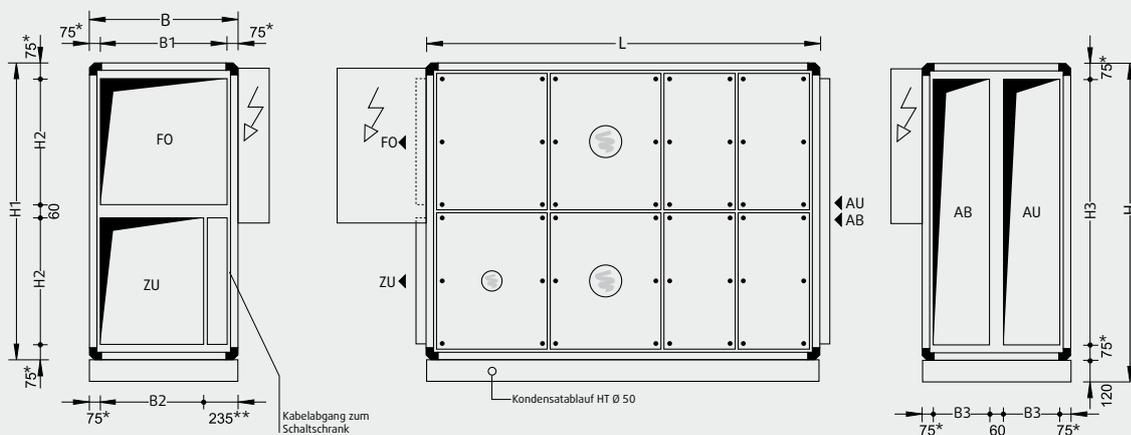
Achtung! Bei einer parallel betriebenen Anlage muss der Zuluft- und Abluftkanal zusammen geführt werden.
