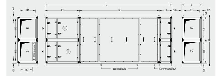
Achtung! Bei einer parallel betriebenen Anlage muss der Zuluft- und Abluftkanal zusammen geführt werden.
